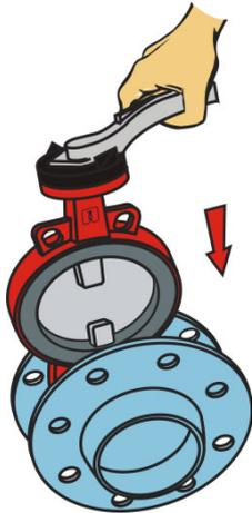
1. Placer la vanne avec un papillon légèrement ouvert entre les brides. La distance entre les brides doit être suffisante pour empêcher un endommagement du siège.
