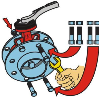
2. Serrer légèrement les brides avec quatre boulons et aligner la position de la vanne.
