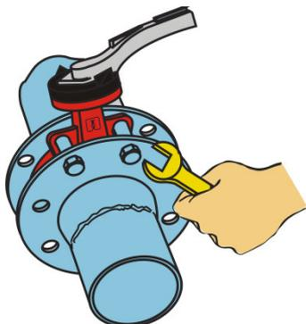
7. Aligner la vanne et serrer légèrement la vanne à l'aide de quatre boulons.
