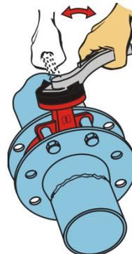
8. Ouvrir l'orifice de la vanne et veiller que le papillon est facile à déplacer.
