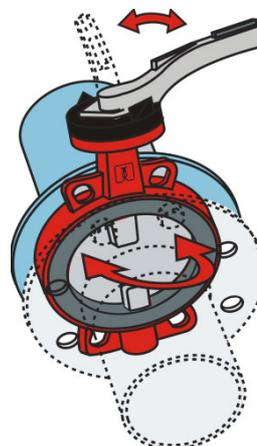
10. Tester le bon fonctionnement de la vanne (le papillon ne doit pas frapper la tuyauterie).
