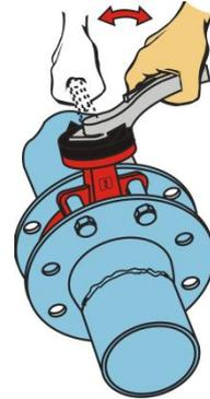
8. Abra la válvula y asegúrese de que la operación de la misma no requiere un esfuerzo excesivo.
