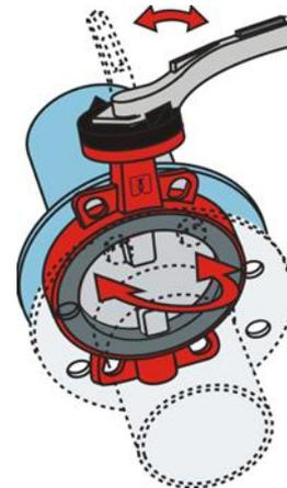
10. Compruebe el correcto funcionamiento de la válvula (el disco no debe tocar la tubería).
