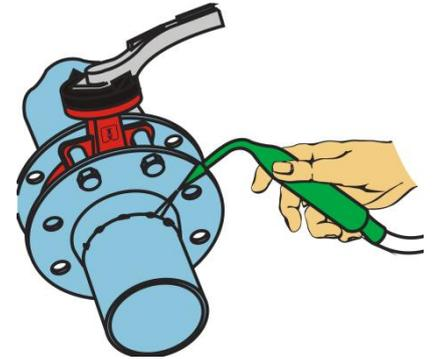
3. Sitúe el conjunto en la tubería y aplique varios puntos de soldadura.
