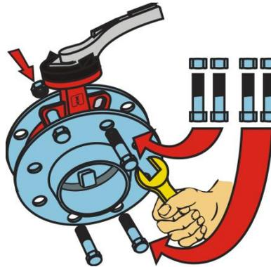
2. Centre la válvula y apriete levemente las bridas con cuatro pernos.
