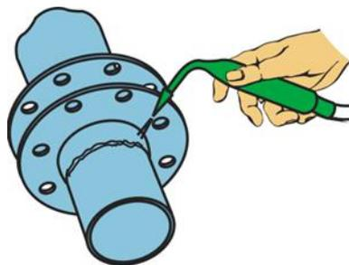
5. Suelde las bridas a las tuberías.
