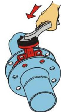
6. Una vez que las bridas se han enfriado, coloque la válvula y asegúrese de que hay suficiente holgura (ver Fig).
