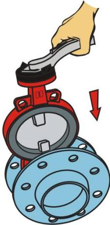
1. Sitúe la válvula, ligeramente abierta, entre las bridas de la tubería. La distancia entre bridas debe ser suficientemente grande para no dañar el asiento de la válvula.
