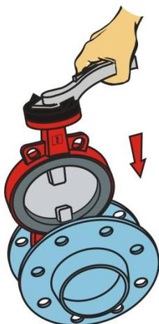
1. Inseriamo la valvola con la farfalla semiaperta fra le flange, che sono abbastanza distanti da impedire il danneggiamento del maniccotto.
