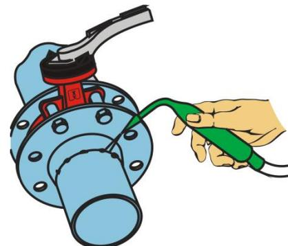
3. Fissiamo le flange ad alcuni punti delle tubazioni mediante saldatura con elettrodo.
