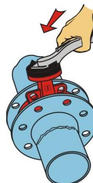
6. Dopo il raffreddamento delle flange reinsertiamo la valvola lasciando un gioco sufficiente (vedi fig. 1).
