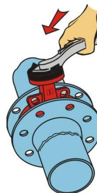
6. Depois de as flanges arrefecerem, voltamos a introduzir a lingueta, novamente com a tolerância suficiente (vide a fig. 1).
