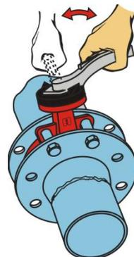
8. Abrimos a passagem pela lingueta e verificamos se a borboleta está facilmente móvel.
