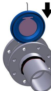
6. После охлаждения фланцев снова вложить клапан, снова с достаточным расстоянием (см. рис. 1). Стрелка на корпусе должна отвечать направлению тока.
