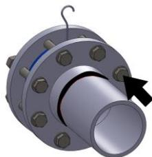
7. Клапан центрировать и слегка привернуть с помощью четырех винтов. Добавить остальные винты (укрепляем „крест-накрест“).
