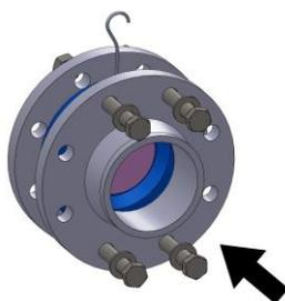
2. С помощью четырех винтов слегка привернуть, сравнить положение клапана.
